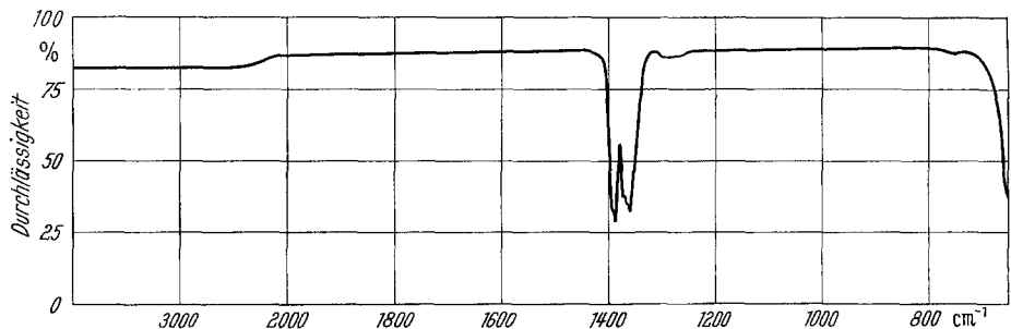
Fig. 1. IR-Spektrum von SNF (50 Torr)
